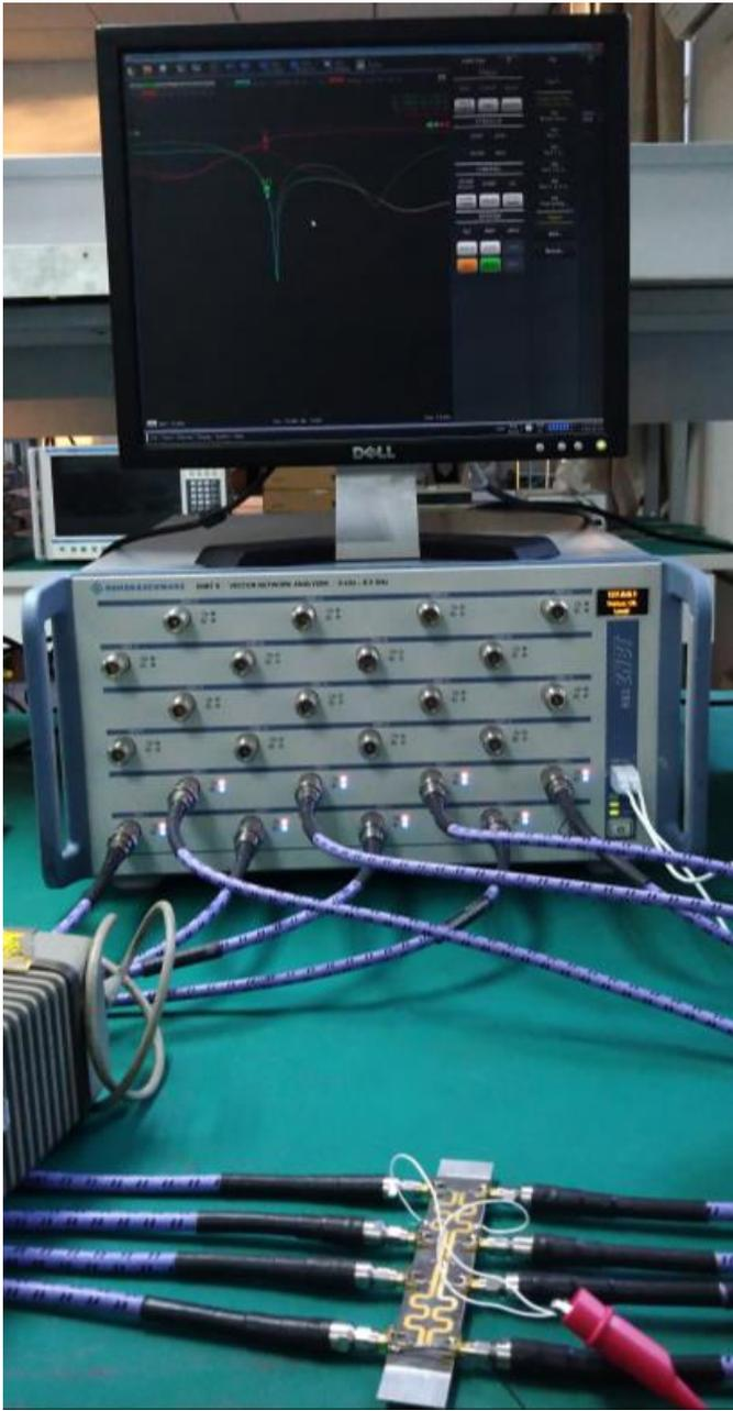
图3 平衡耦合器测试照片
