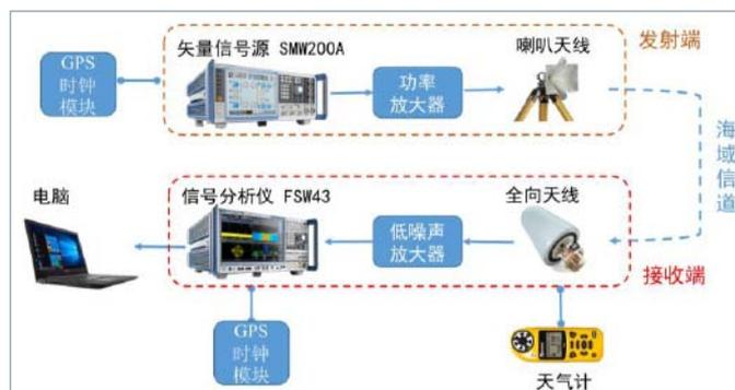
图2 通信系统组成示意图
