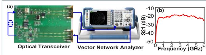
图3 光模块的结构与S21曲线的测试
