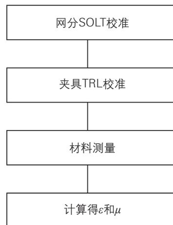
图2 测试流程图
